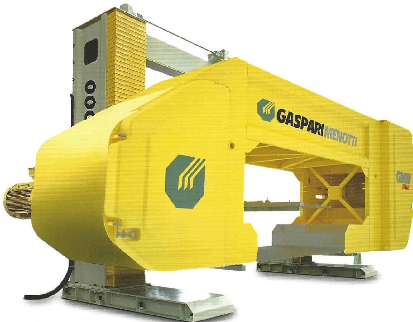
La macchina multifilo GMW2000 è concepita con una struttura a due colonne in cui scorrono i cursori che supportano il castello di taglio ad arco.
