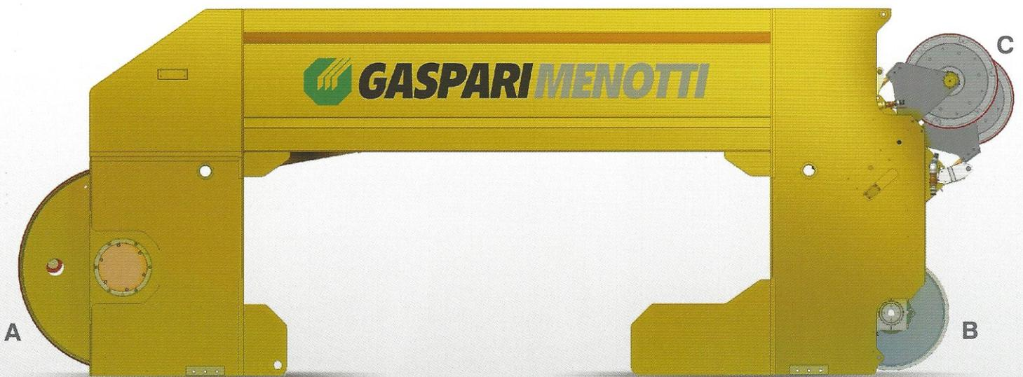
Il filo diamantato è avvolto intorno a 3 rulli, un tamburo motore **A**, un asse folle **B**, una puleggia tenditrice **C**. Il tensionamento del filo avviene diagonalmente sulle pulegge **C**.
